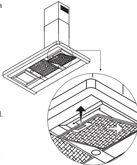
**Replacing Metal Filters**
