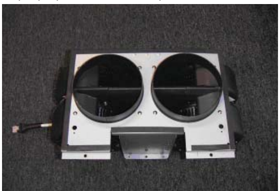
5. Utilisez le ventilateur que vous avez enlevé de la plaque pour ventilateur simple et fixez-le à la plaque pour ventilateur double.
